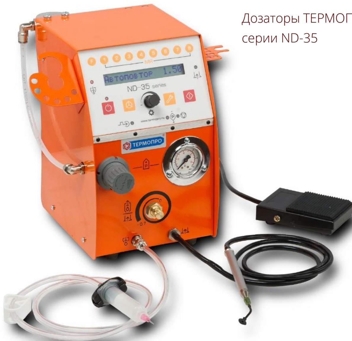
Программируемый дозатор серии ND-35 - промышленный прибор, предназначенный для дозирования паяльных паст, флюсов, клеев, герметиков, смазок и других жидких и пастообразных материалов с помощью пневмоимпульсов. Серия дозаторов ND-35 разработана на базе унифицированной платформы. В серию входит шесть основных вариантов дозаторов, отличающихся функциями и назначением.
